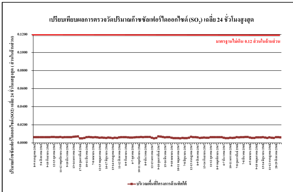
รูปที่ 4.4-18 เปรียบเทียบผลการตรวจวัดปริมาณก๊าซซัลเฟอร์ไดออกไซด์ (SO 2 ) เฉลี่ย 24 ชั่วโมง บริเวณพื้นที่โครงการด้านทิศใต้ ระหว่างเดือนกรกฎาคม 2565-สิงหาคม 2568
